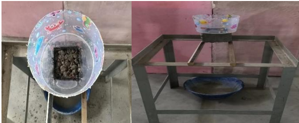
Görsel. 6.Geçirim beton örneklerinin su geçiş süresi ve su geçirme hızı düzeneği
