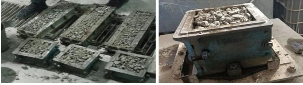
Görsel 4. Taze betonun küp ve kiriş kalıplarına yerleşirmiş görüntüsü
